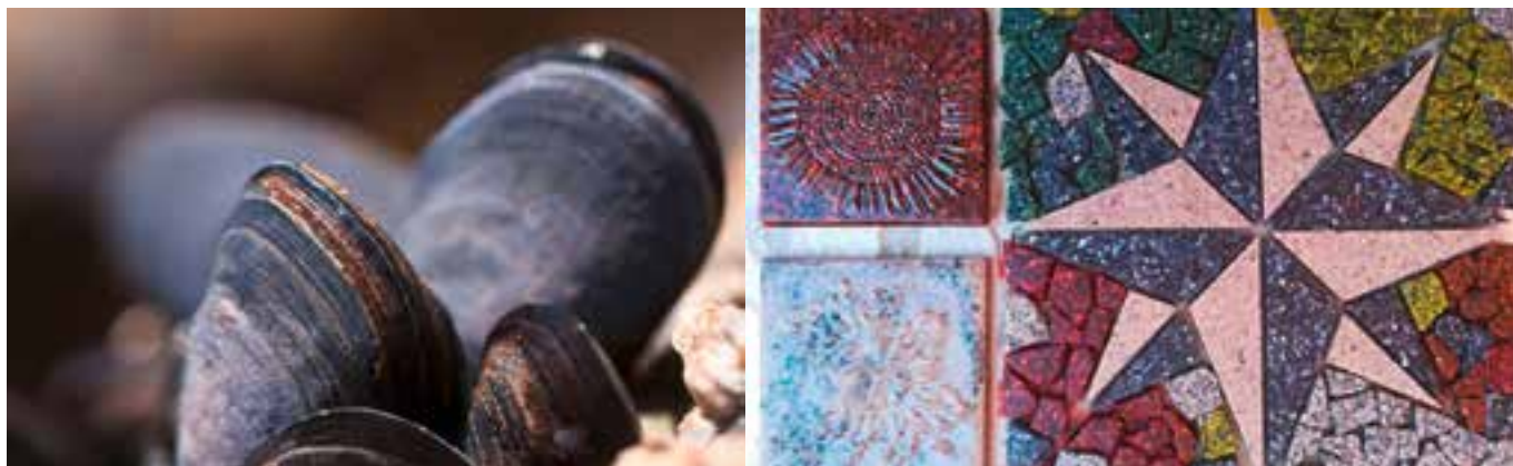
▲ Conchas de mejillón y azulejos hechos con conchas trituradas de mejillón.
